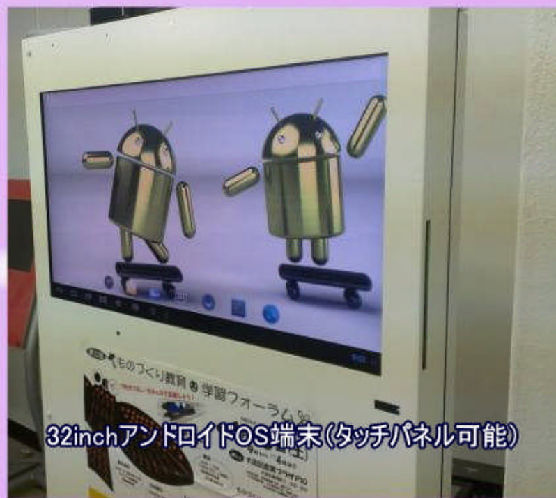
32inchタッチパネル付き電子看板
